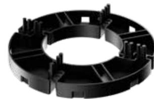
SP1 è un **supporto con altezza fissa 14 mm**. È la soluzione più semplice ed economica per la posa di qualsiasi pavimentazione da esterno autoportante. A seconda della conformazione del sottofondo, può essere utilizzato con i livellatori SP2 (sp. 1 mm) ed SP3 (sp. 3 mm).
