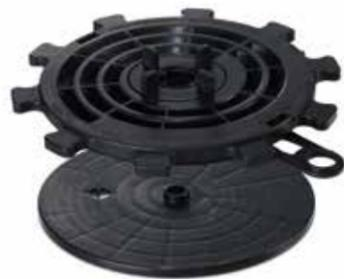
PP Level MINI 10/15 è un **supporto regolabile a testa fissa** e per altezze fino a 30 mm, a completamento della gamma. PP Level MINI è regolabile in altezza da 10 a 15 mm, ma è ulteriormente **estensibile fino a 30 mm** inserendo un massimo di tre prolunghe P/5 da 5 mm ciascuna. PP Level MINI è dotato di alette distanziatrici per fughe da 4 mm, facilmente removibili.
