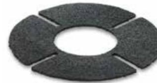
PPL/DLT è un **disco livellante in gomma** da posizionare sulla testa del supporto per spessorare uno o più settori e **compensare piastrelle con spessori non omogenei**.
