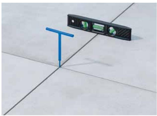
Grazie all'apposita chiave, i supporti PP level DUO MAXI con testa autolivellante per pavimenti in ceramica possono essere regolati in altezza anche a pavimento finito, per ottenere **pavimentazioni perfettamente livellate**. Per una regolazione più rapida, è disponibile un inserto in acciaio per avvitatore.
