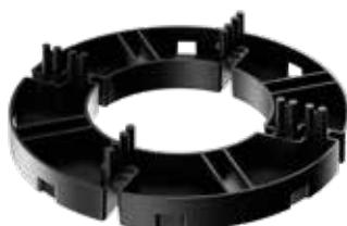
PP Level MINI 10/15 è un **supporto regolabile a testa fissa** e per altezze fino a 30 mm, a completamento della gamma. PP Level MINI è regolabile in altezza da 10 a 15 mm, ma è ulteriormente **estensibile fino a 30 mm** inserendo un massimo di tre prolunghe P/5 da 5 mm ciascuna. PP Level MINI è dotato di alette distanziatrici per fughe da 4 mm, facilmente removibili.
